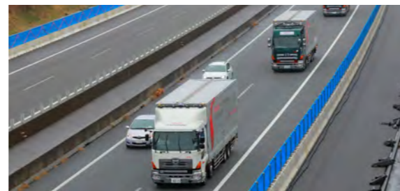
車間距離自動制御による高速道路での自動隊列走行
