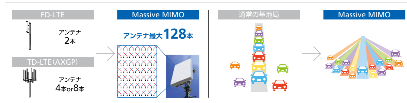
超高速・大容量通信を実現する「Massive MIMO」
