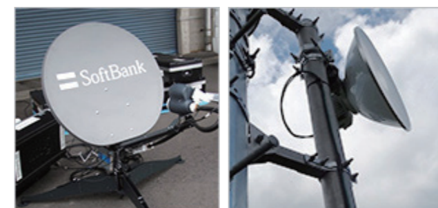
可搬型衛星アンテナ
