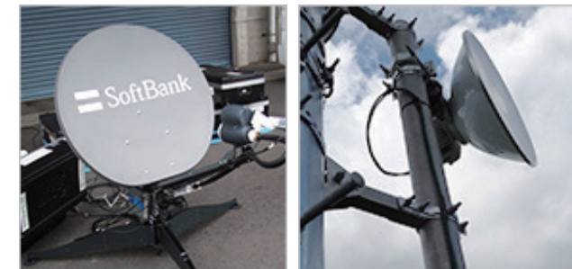
可搬型衛星アンテナ
