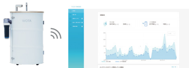
センサーと水処理AIでWOSHの状態と水質を監視・制御。何か起これば、すぐに通知され、ダッシュボードで確認可能
