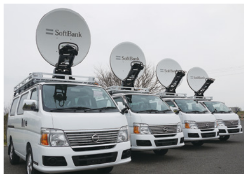
可搬型移動基地局
