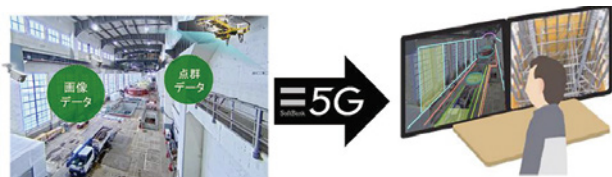
建設現場(現実空間の画像・点群を取得) / オフィス(仮想空間の建設現場を確認)
