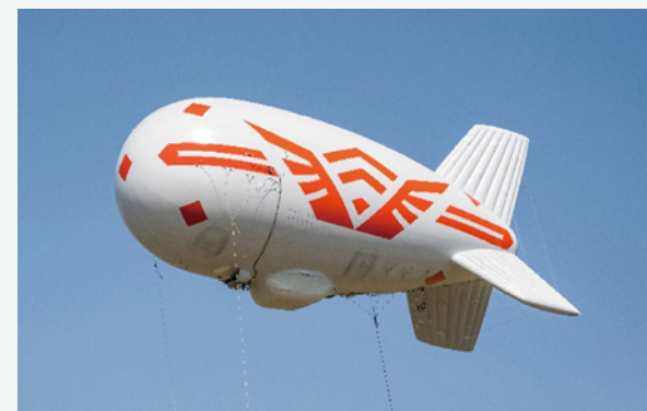
北海道で行った実証実験で使用したAltaeros社の高高度係留気球
