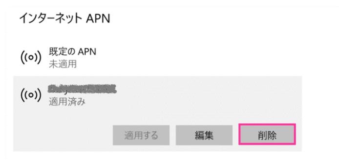
「既定の APN」を除き、作成されている全ての APN（プロファイル）を削除します。
