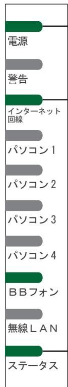
「電源」ランプが消灯している場合、光BBユニットの電源アダプタを正しく接続してください。
